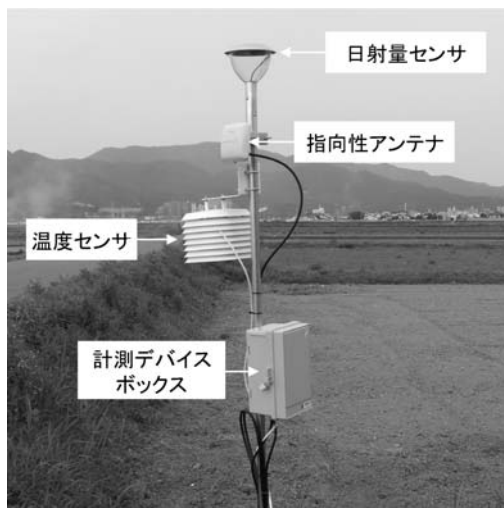
図1 圃場気象環境情報モニタリング装置の構成
