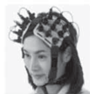
48ch 光トポグラフィー
