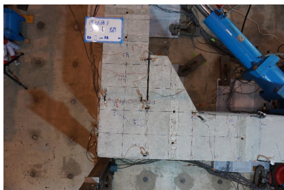
写真-4.7 2\delta y の損傷状況（供試体 Lo）
