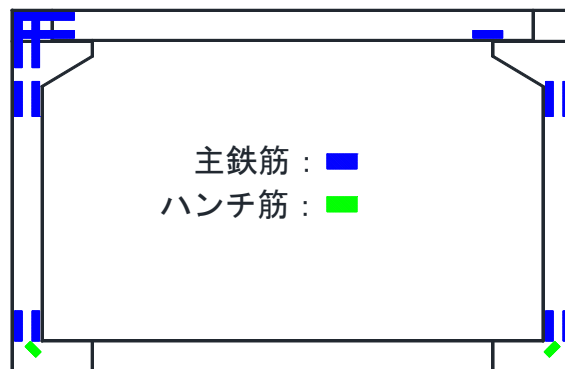
図－3.43 3.3 節ケース 4 鉄筋降伏状況図
