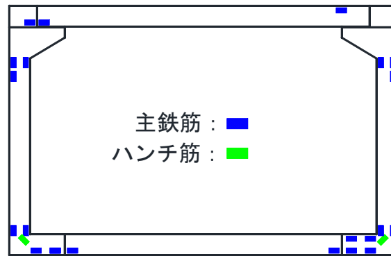
図－3.21 実験の鉄筋降伏状況図
