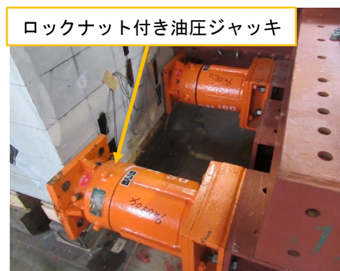
写真-2.4 水平方向支持状況
