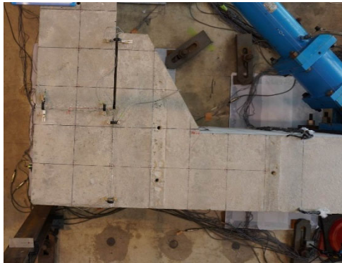
写真－5.1 ひび割れ発生時の平面（実験）
