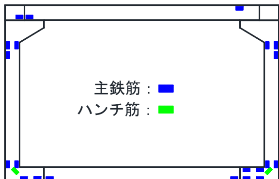
図－3.42 実験の鉄筋降伏状況図
