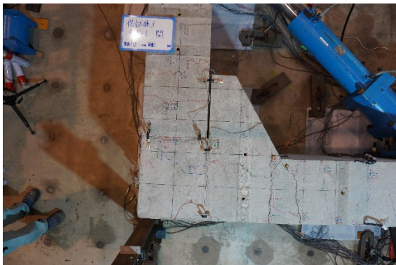
写真-4.9 4δyの損傷状況（供試体 Lo）
