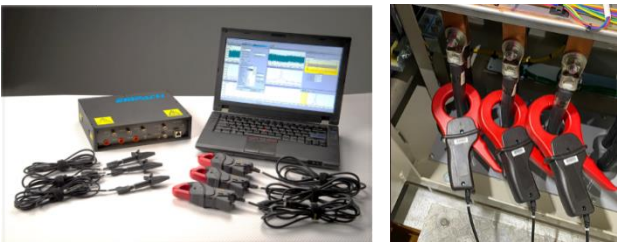
図 4 EMPATH™システム一式と電流測定の様子
