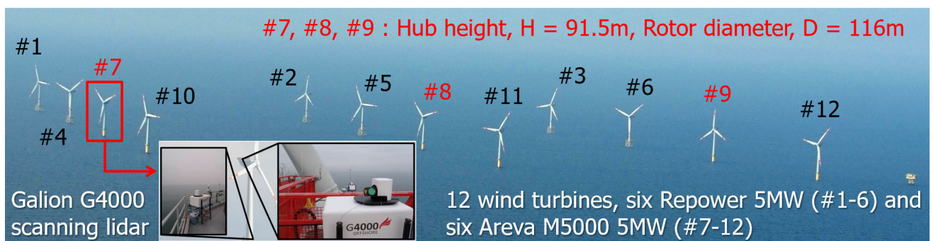
図1 ドイツで初めてのオフショア・ウインドファームであるAlpha Ventus Offshore Wind Farm (5MW×12)
