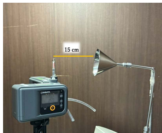
図2. GC-MS分析に供するために収集中のマートル香気成分 生理学的測定試験と同様にマートル精油を呈示し、エアポンプ (SIBATA) に装着したTenax TA捕集管にマートル精油の香気成分を吸着させた。
