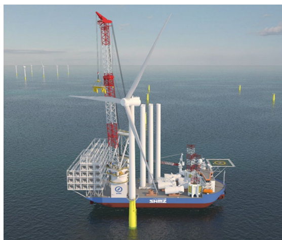
(a) SEP 船による施工の様子（出典：清水建設株式会社 [18]）
