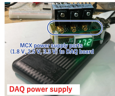
Fig. 2 データ収集系のボードに電源を供給可能な自作電源
