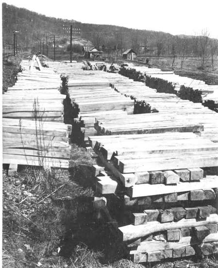
図2-11 国鉄上利別駅の枕木製材品
