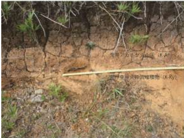
試料検出状況 鬼界アカホヤ火山灰最下部の火山豆石層下約0.2mのレベル
