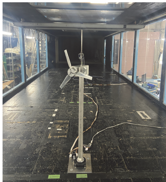
図 7 風車模型回転装置を使用した実験
