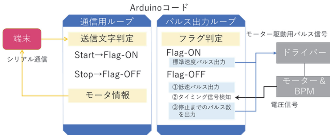
図 10 ステッピングモーターの Arduino コード概要
