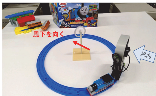
図 3 パッシブヨーデモの卓上風車模型
