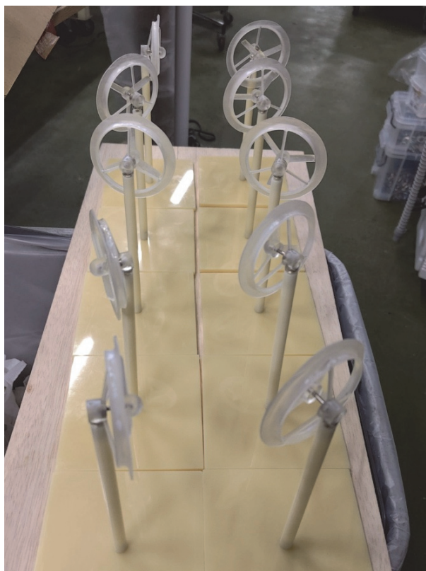
図 2 ベアリング搭載型の卓上風車模型
