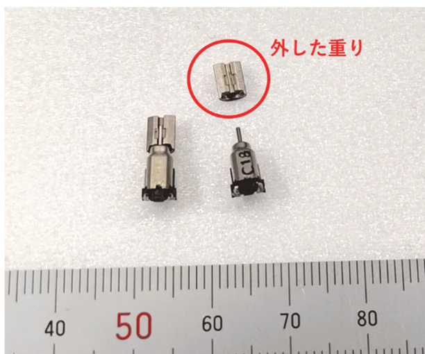
図 4 使用した DC モータ
