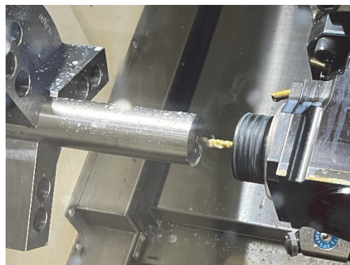
図5 \Phi 6\text{mm} のドリルを用いた加工の様子
