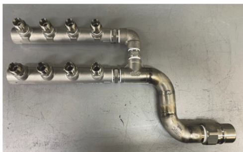
図 3 延長したヘッダーの一部
