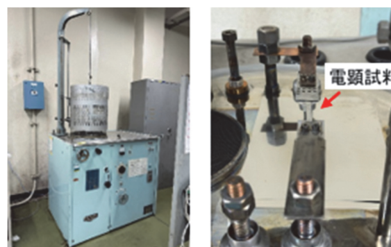
図 5 真空通電加熱炉（左）と通電部（右）
