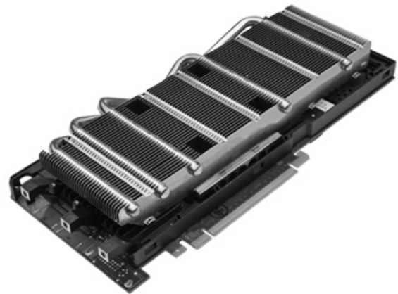
図3 本研究で使用したGPU, Tesla® M2090 (512CUDAコア, 6GBメモリ) x 4枚 【構成】
