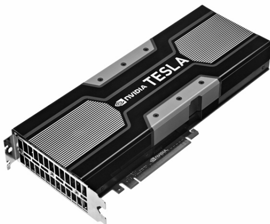
図2 本研究で使用したGPU, Tesla® K20X (2688CUDAコア, 6GBメモリ) x 1枚
