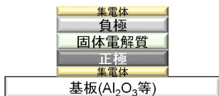
図.1.4 薄膜型全固体電池及びバルク型全固体電池の概略図
