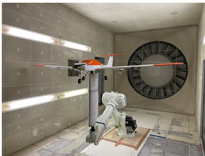
図 5.7 第2測定部内に設置した産業用ロボットと Phoenix-S
