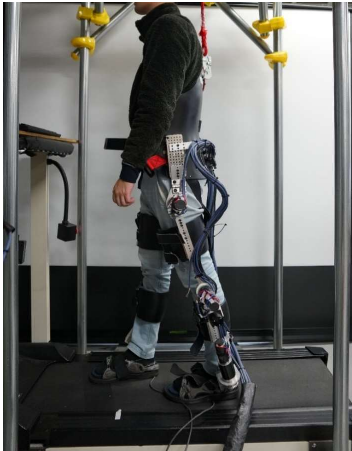
図 1-2 下肢外骨格型アシストロボットによる歩行動作支援 [49]
