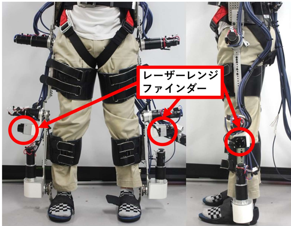
図 1-4 レーザーレンジファインダーを用いた下肢外骨格型アシストロボットにおけるユーザー動作意図の推定 [49]
