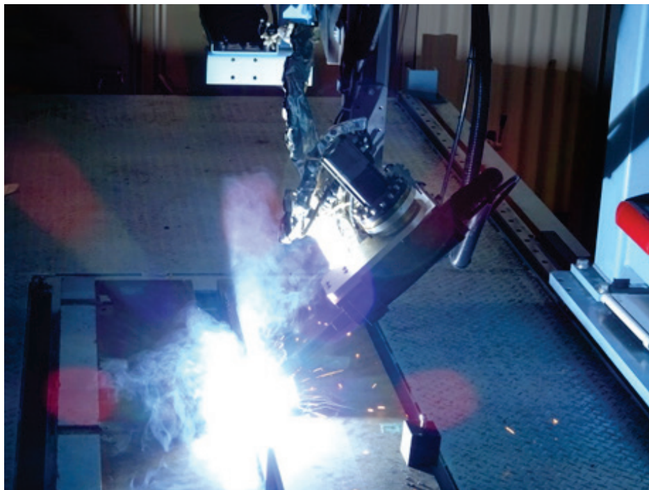
Fig. 2-3 Horizontal fillet weld test
