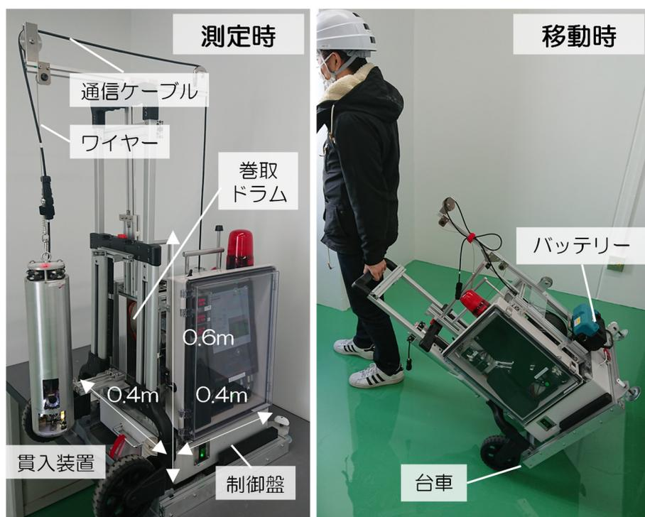
図 4.4.1 測定時および運搬時の装置全景
