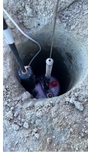
図 4.5.12 原位置挿入型針貫入試験
