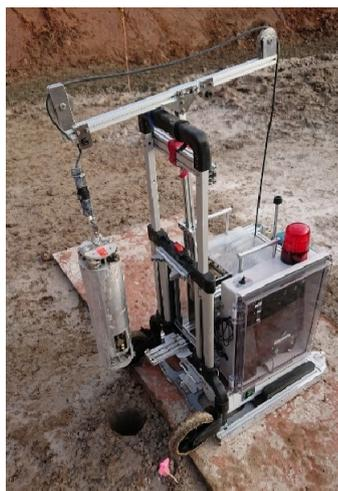
図 4.5.8 原位置挿入型針貫入試験
