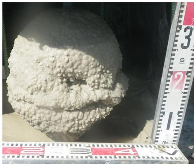
図 1.1.11 固化体の形成状況<sup>15)</sup>
