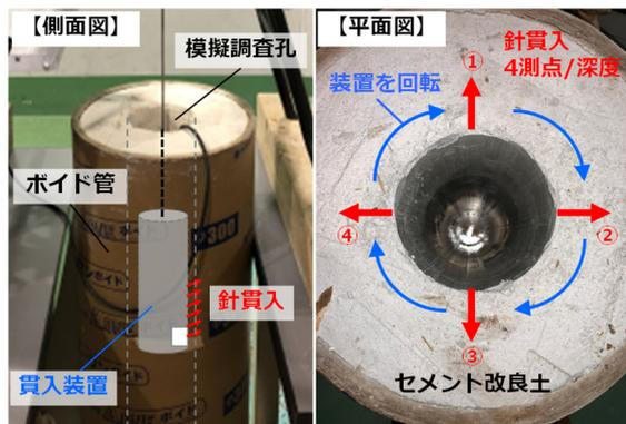
図 4.3.2 原位置挿入型での測定
