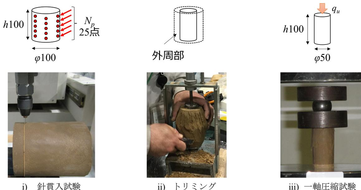
図 3.6.1 測定試験の流れ
