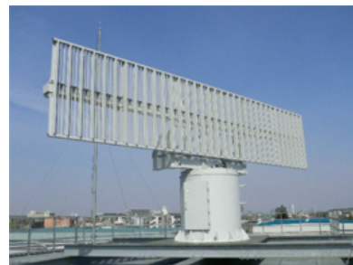
第2図 電子航法研究所の SSR モード S のアンテナ
