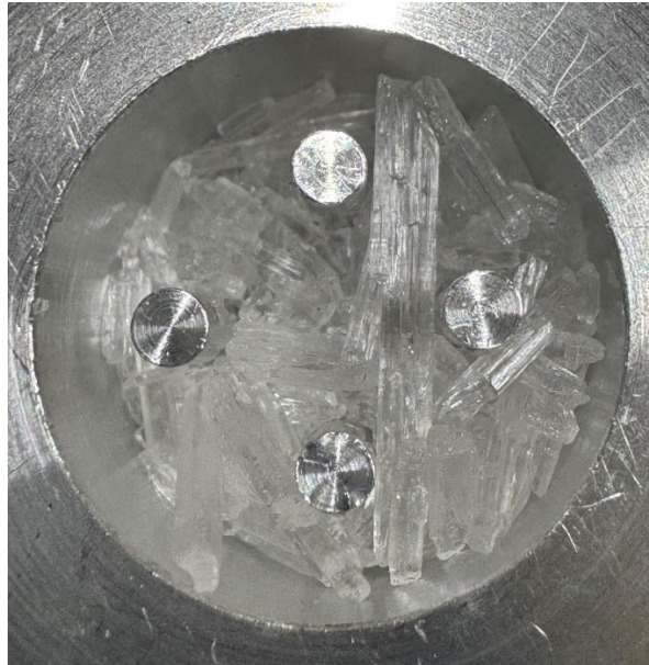
図 4-3 L-メントールを投入した推進剤タンク内部
