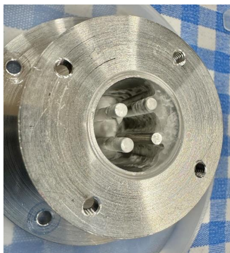
図 6-9 L-メントールの実験後のタンク内画像
