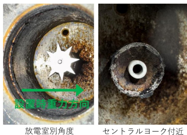
図 7-3 L-メントールでの堆積物除去結果での別角度からの画像
