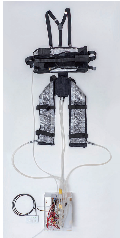
図 7 失禁体験装置の全体図。腹部への空気圧圧迫機構と股間部への温水を用いた温感提示により尿失禁感覚を提示する。
