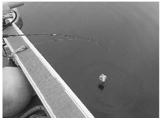
Fig. 5 GNSS 受信機を内包した小型ブイを海面に降ろすところ
