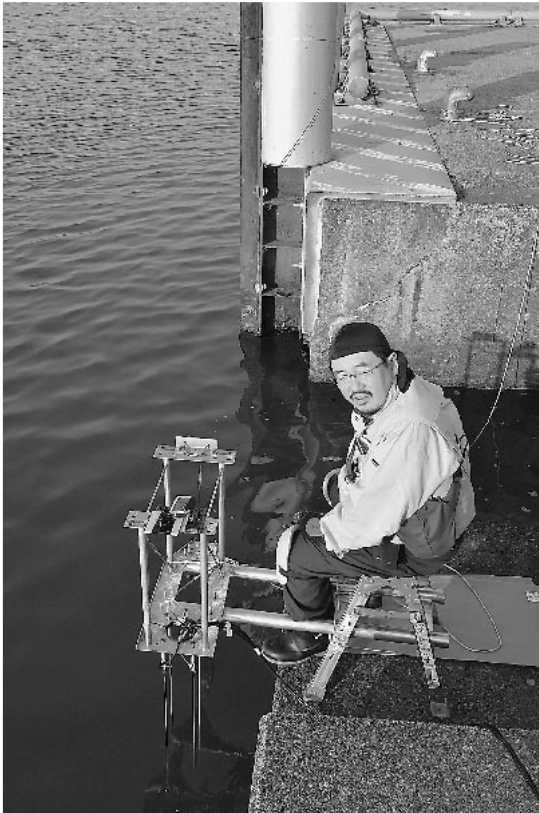
Fig. 1 ワイヤー式水位計（可搬式）。
