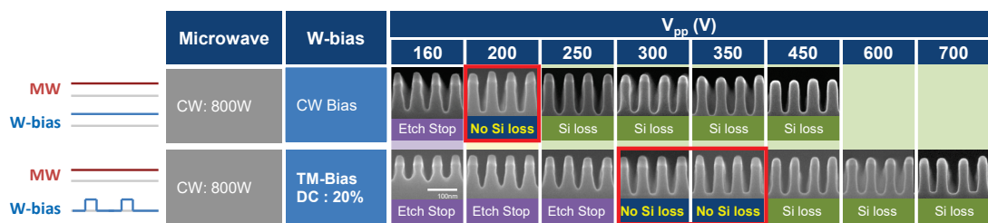
図 3-23 poly-Si ゲートエッチング形状の V_{pp} 依存性(15%オーバーエッチング)
