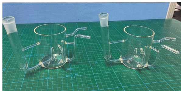
図 7 改良したガラスセル
