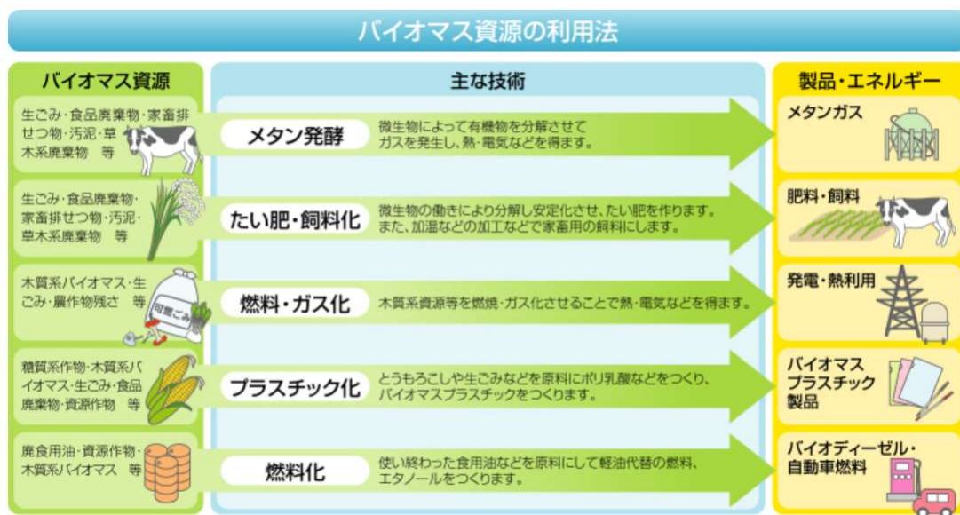
図 1-2. バイオマス資源の転換利用法の例（出典：市原グリーン電力ホームページ；
