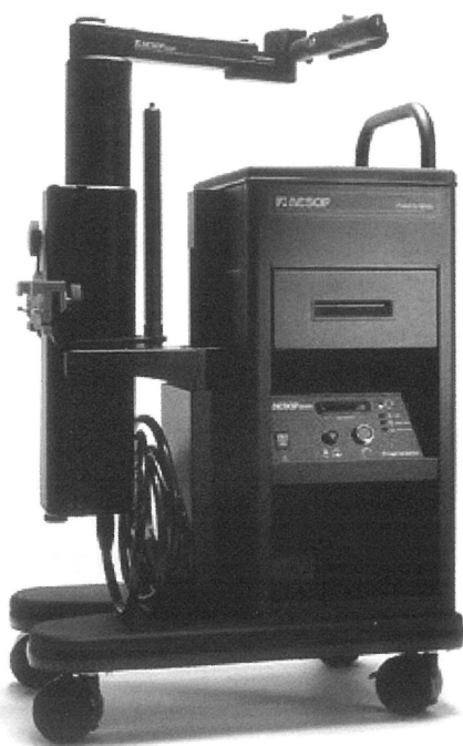
図1 音声認識内視鏡保持ロボット AESOP の概観
