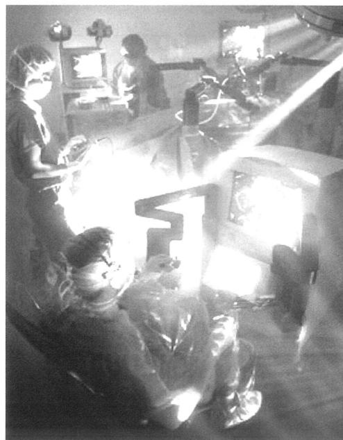
図2 ゼウス ZEUS による手術風景(合成写真) 手前の術者用コクピットでモニターを見ながら術者が ZEUS をコントロールしている．背後には ZEUS のアームを取り付けた手術台が見え，患者が横たわっている．
