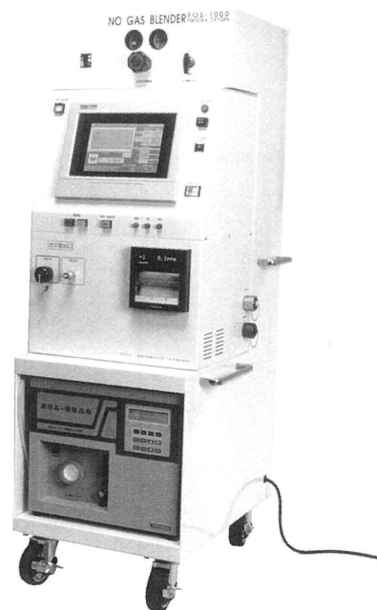
図3 一酸化窒素供給装置 フィードバック機構を有し、濃度の自動調節が可能である。
