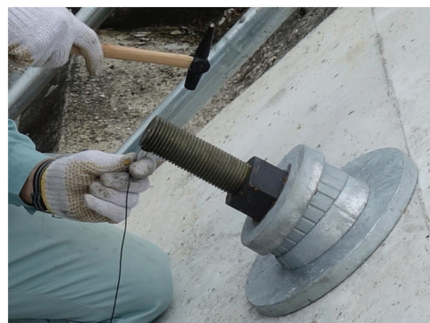
写真-1 AEセンサを用いた計測状況
