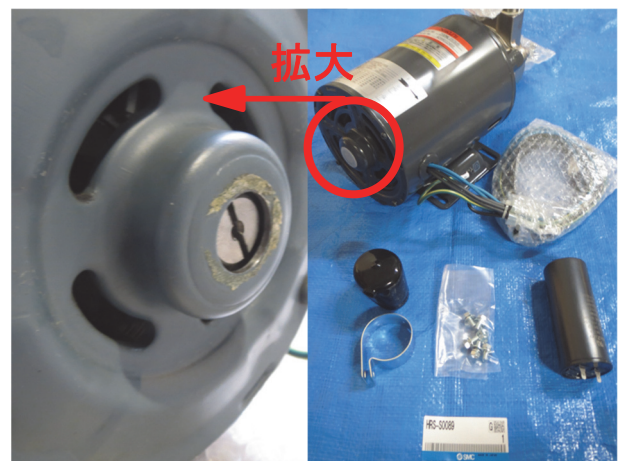
図9 手動回転構造およびポンプのスペアパーツ
