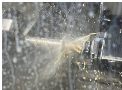
図7 \Phi 20\text{mm} のドリルを用いた加工の様子
