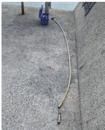
図 10 水位計を取出した様子
