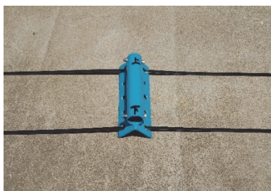
図 6 今津設置用の水位計フレーム
