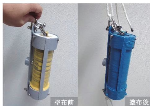
図 4 小呂島設置用の水位計とフレーム
