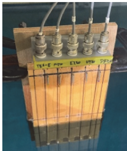
図 2 作製した波高センサ
