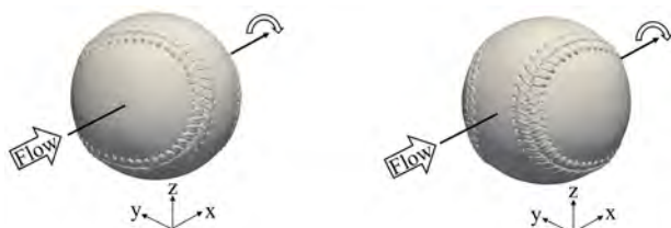
図2 ジャイロスピンにおける2種類の縫い目の回転(左: 2-seam回転, 右: 4-seam回転)
