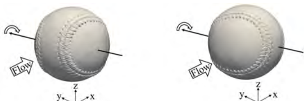
図1 バックスピンにおける2種類の縫い目の回転(左: 2-seam回転, 右: 4-seam回転)
