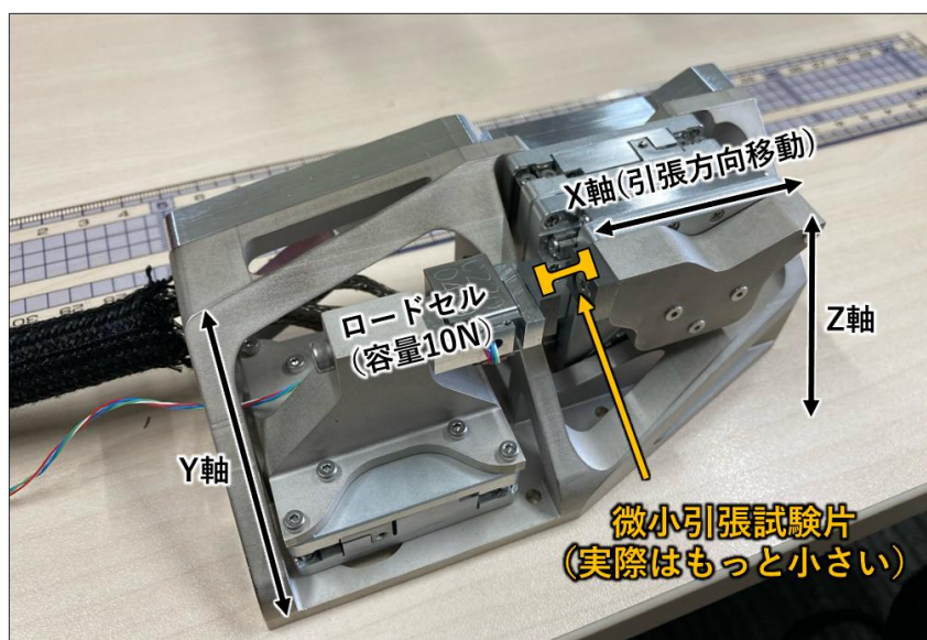
図 2-4 微小引張試験機.
