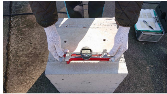
(b) ホイットモアストレーンゲージ による表面の長さ変化の計測
