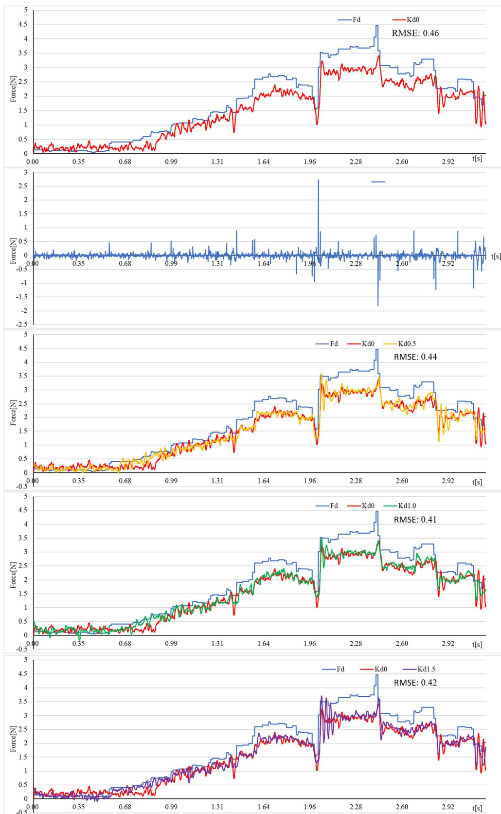
図 2-10 K_d を変化させたときの 1 本の腱の張力制御結果
