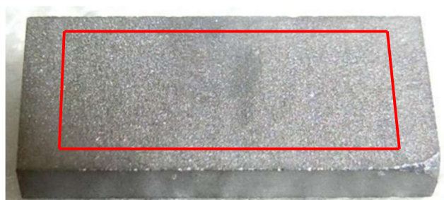
図 3.12 測定用に切り出した接合試料及び、ゼーベック係数マップの作成範囲
