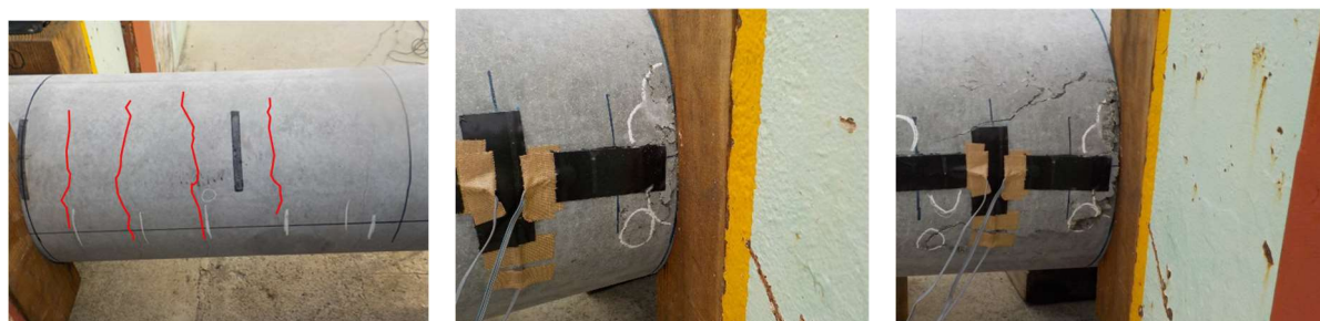
(a) 引張側ひび割れ (載荷中) (b) 圧縮側ひび割れ (載荷 250 回) (c) 圧縮側ひび割れ破壊前 (載荷 380 回)
