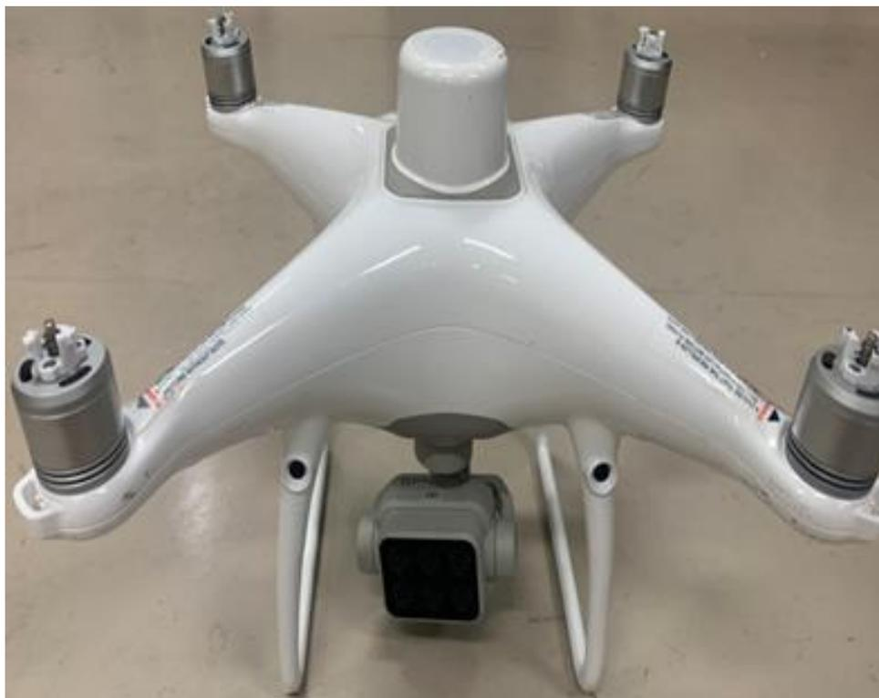
図 2.2 本研究で使用した空撮ドローン (DJI 社製 P4 Multispectral)
