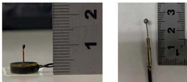
Figure 2 左：小型サーミスタ風速計、右：従来のサーミスタ風速計
