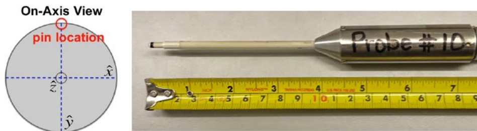
図 3.1 大阪大学所有の磁気プローブの外形 先端に4回巻かれたコイルを通る磁束によって誘導起電力を検出する
