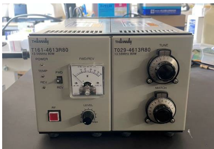
図 3.6 高周波電源およびマッチングボックス
