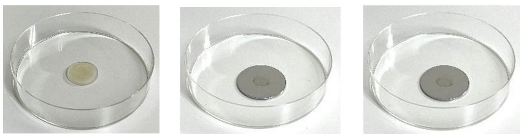
図 3.18 培養後のバイオフィルムの様子 (左：CaF 2 板、中央：ステンレスプレート：右：アルミニウム)
