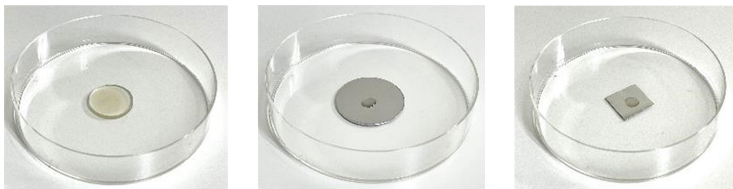
図 3.17 サンプル混合液滴下後の様子 (左：CaF 2 板、中央：ステンレスプレート：右：アルミニウム)
