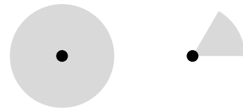
第 1 図 ロボットの情報取得範囲。2次元の場合は、ロボットを中心とした円（左）や、進行方向に扇状に広がる範囲（右）を考えることが多い。
