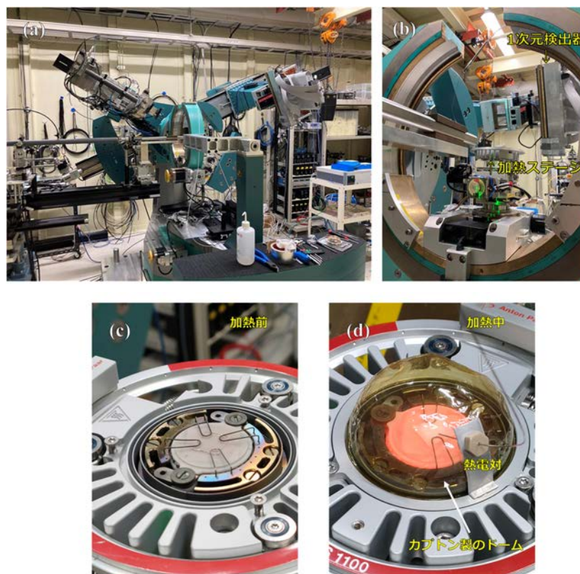
Fig. 7-2 in-situ XRD 測定に使用した測定装置．(a) 測定装置の外観．(b) 1次元検出器と加熱ステージ．(c) 加熱前のサンプルと加熱ステージの様子．(d) 加熱中のサンプルと加熱ステージの様子．
