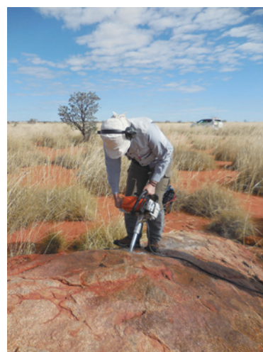
西オーストラリア・ビルバラにて古地磁気測定用の定方位試料を採取中の筆者
