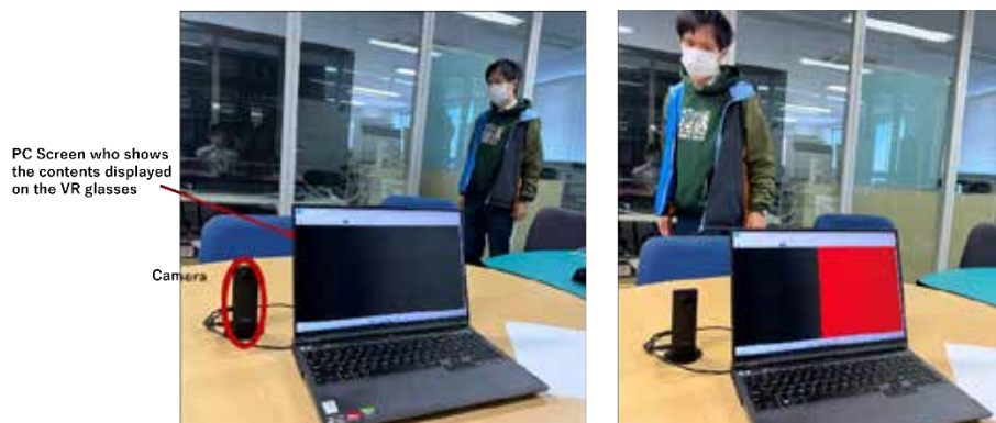
【図2】FairMot を利用し、構築したプロタイプで歩行者検知実験
